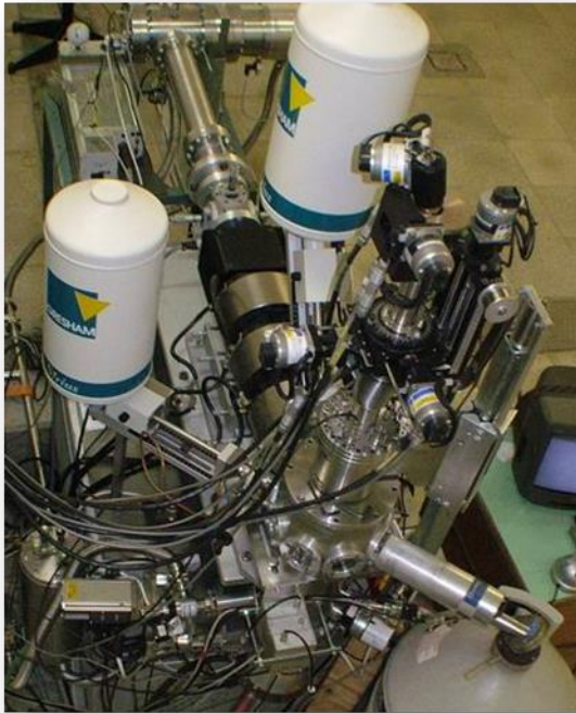
2. kép A debreceni MTA ATOMKI-ban a van de Graaff generátor egyik nyalábjára épített nukleáris mikroszonda, a \mu PIXE.
