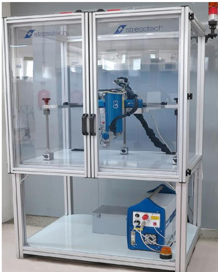
1. kép Stresstech gyártmányú Xstress 3000 G3R röntgen-diffraktométer (Miskolci Egyetem, Fémteni, Képlékenyalakítási és Nanotechnológiai Intézet) maradó feszültség és textúra meghatározására
